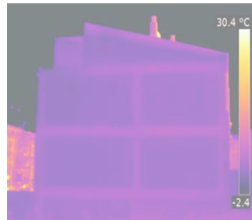
Termografía de vivienda aislada con sistema SATE. Reducción de pérdidas caloríficas, lo que supone un importante ahorro energético en los sistemas de climatización.
